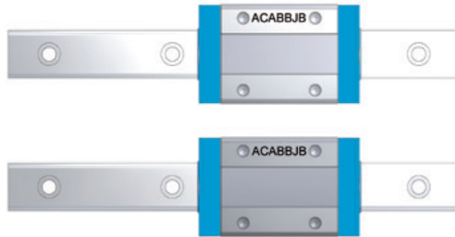
Bild 3.4 Kennzeichnung der Haupt- und Nebenführung
